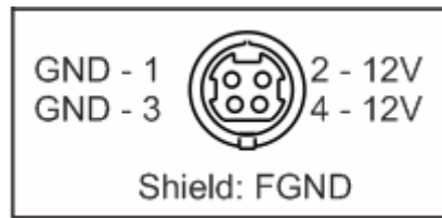
Figure 12 –POWER DIN Plug Polarity
